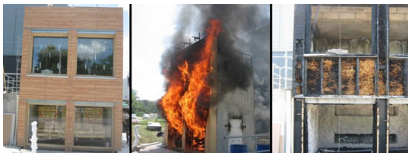
Fig. 32 : Test de résistance au feu d'une façade en paille (CSTB, France)
